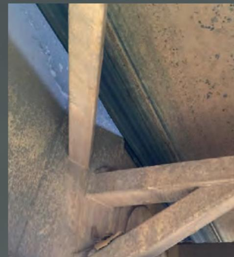
**Un nastro non allineato:** può danneggiare la struttura del nastro trasportatore
